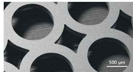
不锈钢精密切割。样图由FTMC提供
