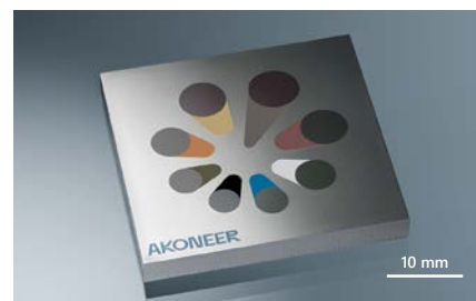
不锈钢利用GHz burst 进行各色 彩色打标。样图由Akoneer提供
