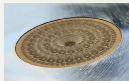
テクスチャ加工したアルミニウム金型。 FTMC 提供。
