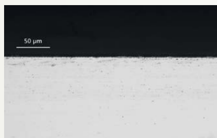
スクライブした 4.8 mm ソーダ石灰ガラスの端面。 FTMC 提供。
