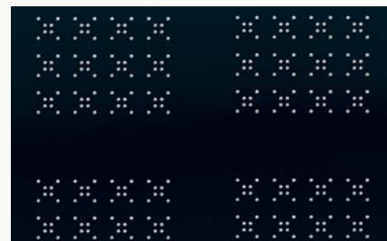
ガラス貫通ビアの選択的レーザーエッチング (SLE)。 WoP 提供。
