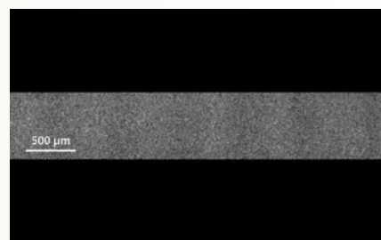
スクライブした 1 mm ソーダ石灰ガラスの側壁。 FTMC 提供。
