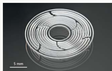
薄板溶融シリカの切断。 FTMC 提供。
